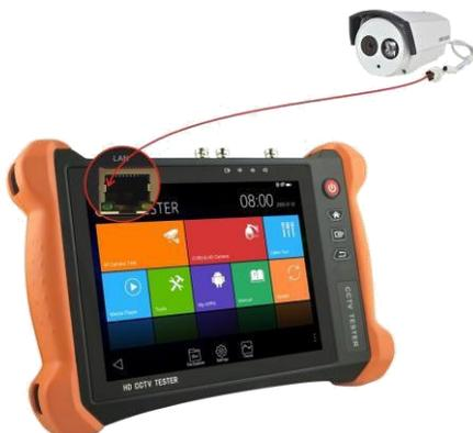
с. Максимальная выходная мощность PoE прибора составляет 24 Вт. Если произойдет сверхмощная нагрузка, тестер перейдет в режим защиты.
