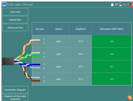
**Протестируйте один раз:** Проверьте состояние кабеля, длину и затухание.
