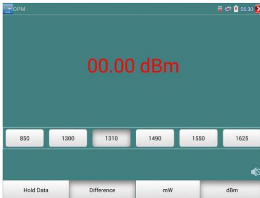
Удержание данных и относительное измерение используются вместе, данные желтые, пока функция действует.
