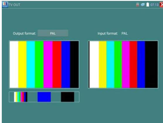
**Тест петли BNC:** Тестер может отправлять и получать генератор цветных полос через видеовыход тестера и
