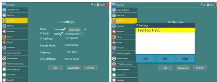
После установки расширенного IP-адреса (см. Фотографии выше) устройство может протестировать два сетевых сегмента (192.168.5.0) и (192.168.1.0).
