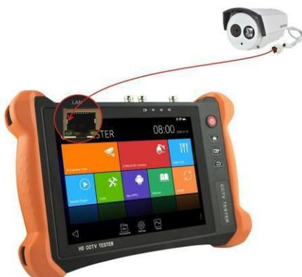
**Примечание:**1) Если IP-камере требуется питание PoE, подключите IP-камеру к LAN-порту IP-тестера. Тестер подает питание PoE для IP-камеры. Щелкните значок с надписью POE, чтобы выключить или включить питание PoE.
