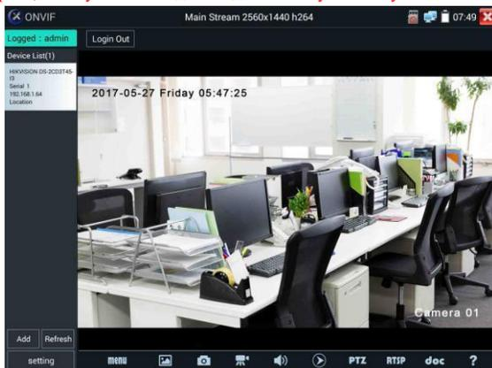
Если вы выбираете режим ONVIF Rapid, измеритель автоматически сканирует различные сегменты сети на предмет камер ONVIF. Он перечисляет имя камеры и IP-адрес в списке устройств. Тестер может автоматически входить в систему и отображать изображение с камеры.
